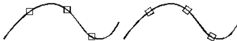
Block nicht am Objekt ausgerichtet.
